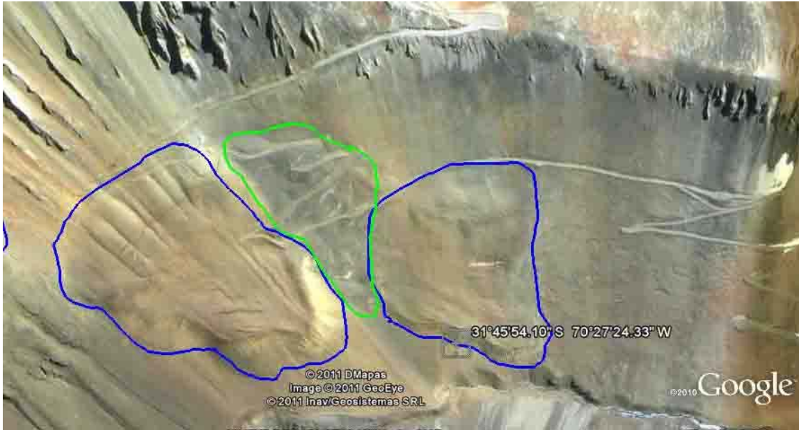
Caminos mineros zigzagean a través de, adyacentes a, o próximos a 3 Glaciares de escombro
