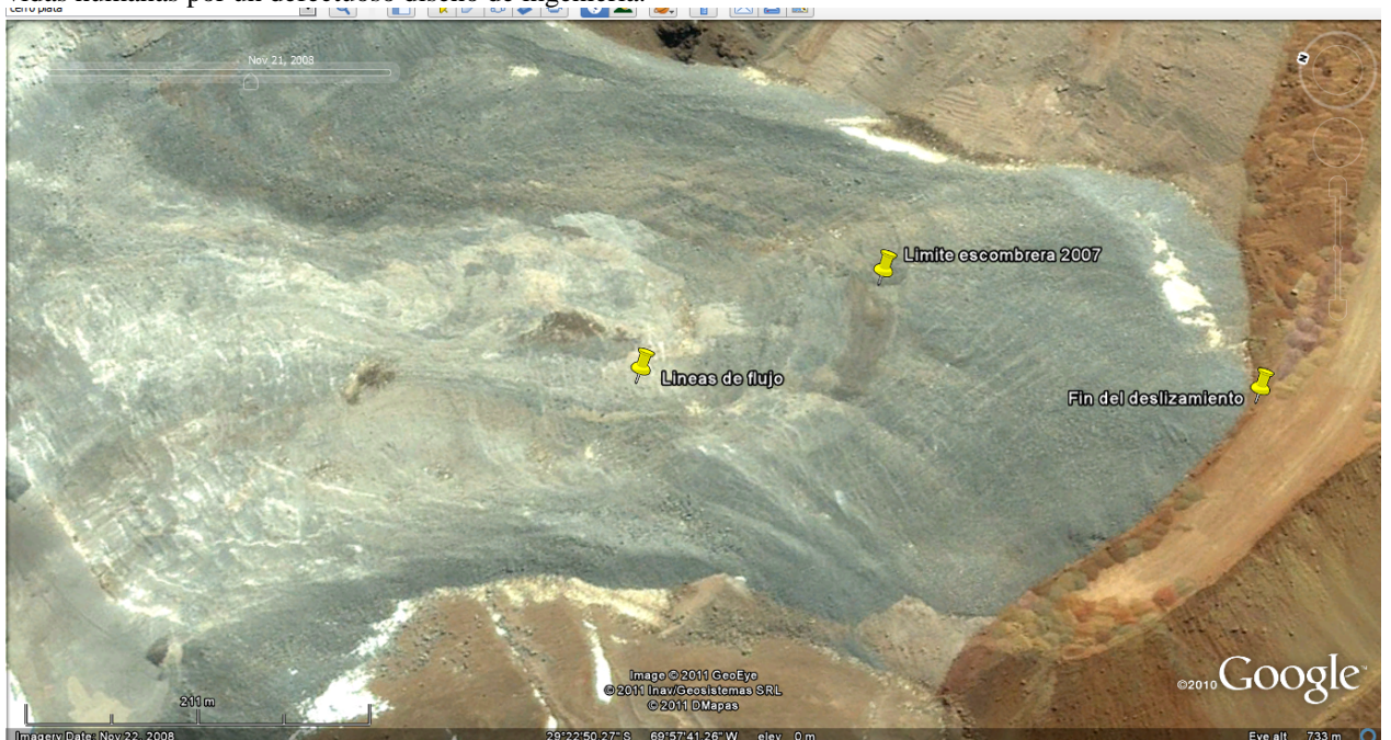
Fig. 9: Otra vista del fin del deslizamiento que paró casi sobre un camino, lo que podría haber causado pérdida de vidas humanas por un defectuoso diseño de ingeniería.
