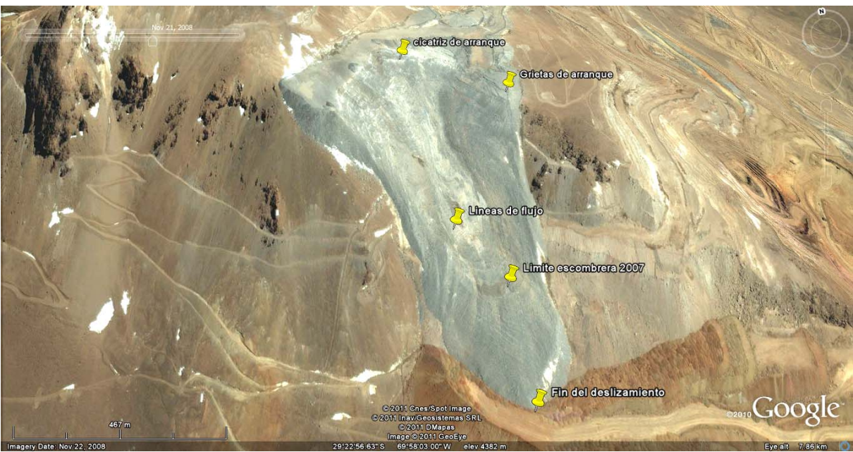
Fig. 4: Vista de la escombrera luego de haber colapsado y fluido como deslizamiento de ladera (landslide). Un proceso conocido por su alta peligrosidad. Este tipo de deslizamientos han matado ya a muchos miles de personas. , conocidos
