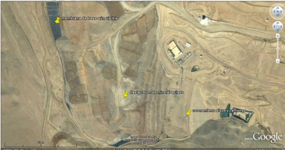
Fig. 4: Vista de la escombrera luego de haber colapsado y fluido como deslizamiento de ladera (landslide). Un proceso conocido por su alta peligrosidad. Este tipo de deslizamientos han matado ya a muchos miles de personas. , conocidos
