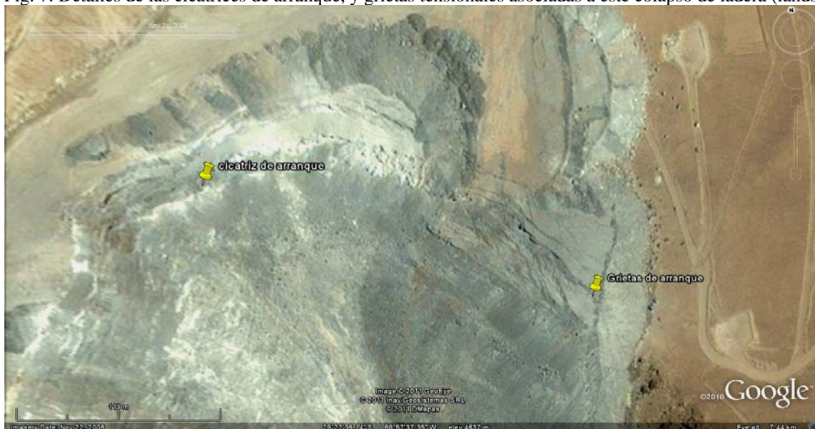
Fig. 7: Detalles de las cicatrices de arranque, y grietas tensionales asociadas a este colapso de ladera (landslide)
