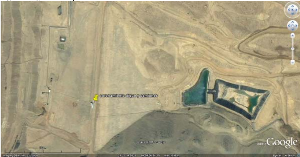
Fig. 3: Proceso de impermeabilización con una membrana de 8mm sobre la cual se pondrán hasta más de 100 m de espesor de mineral, todo embebido en cianuro. Una bomba ambiental de tiempo. Imagen 2007.
