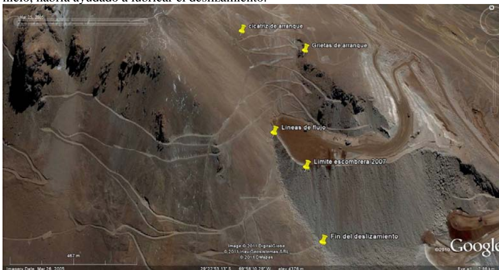
Fig. 7: Detalles de las cicatrices de arranque, y grietas tensionales asociadas a este colapso de ladera (landslide)
