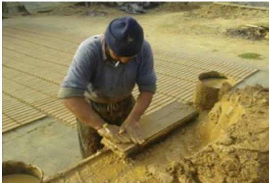
Ladrillos hechos a mano vs. uso de maquinas extrusora que produce ladrillos huecos (mas uniformes y con menos material)
