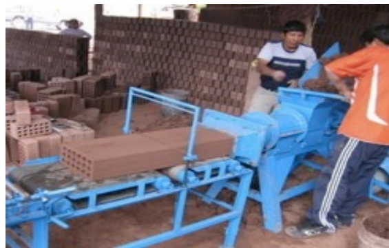
Ladrillos hechos a mano vs. uso de maquinas extrusora que produce ladrillos huecos (mas uniformes y con menos material)
