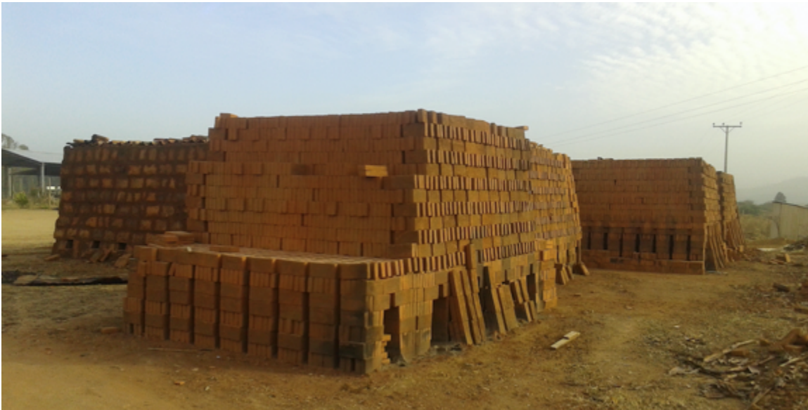
Tres hornos tradicionales en Cauquenes Chile. El horno al fondo a la izquierda ha sido sellado y está listo para la cocción.
