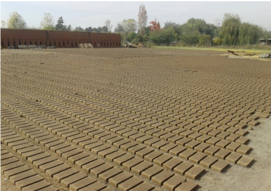
Trabajadores ancianos moldean y colocan ladrillos en el piso a mano
