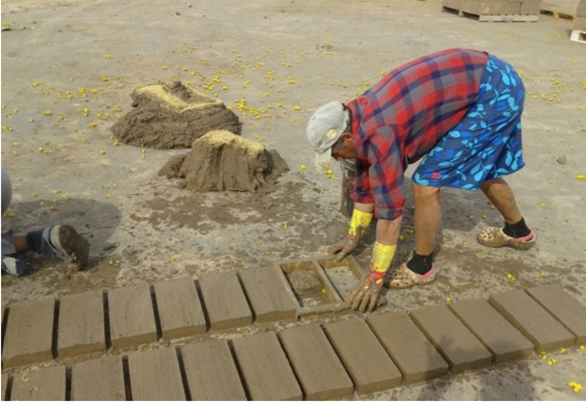
Trabajadores ancianos moldean y colocan ladrillos en el piso a mano
