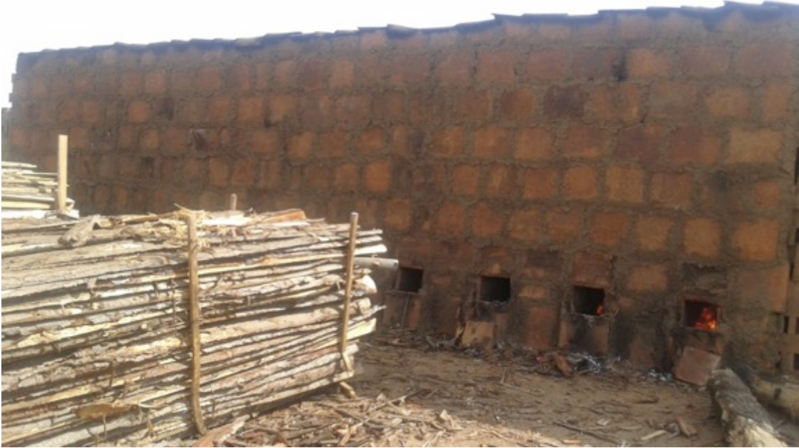
Madera cruda, diseño pobre de horno, y la falta de oxígeno, resultan en mala combustión y contaminación.
