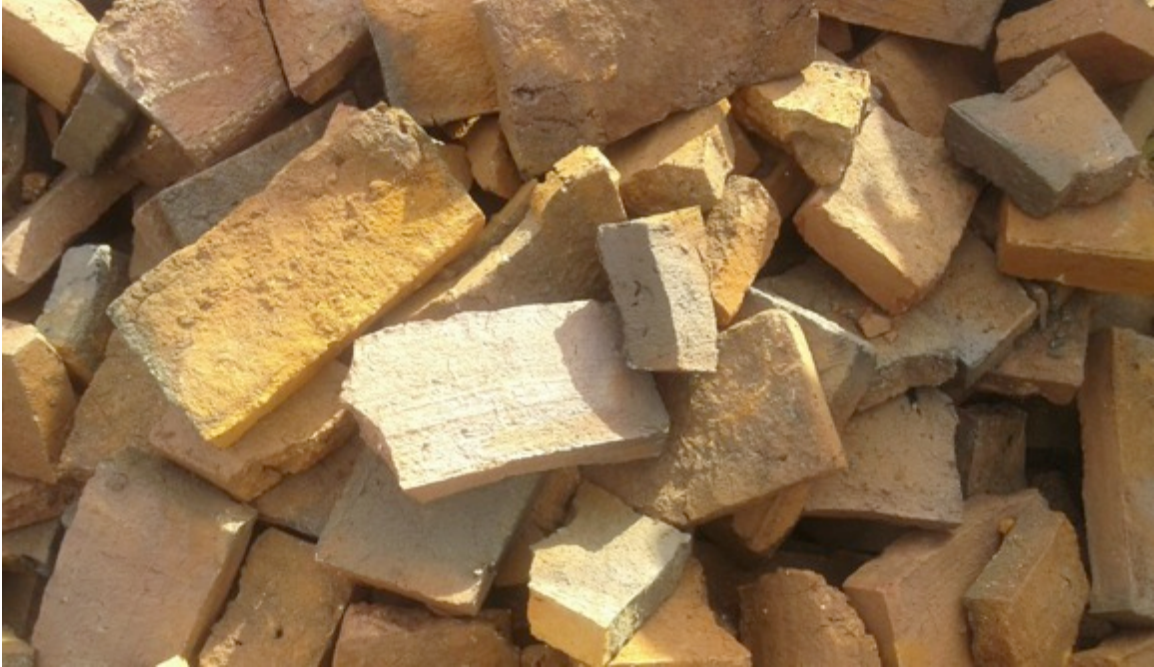
La mala mezcla de arcilla y la mala quema resultan en baja calidad de producto con mucho desperdicio.
